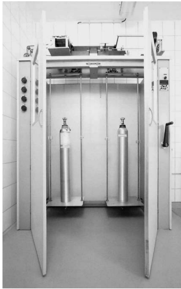
Abbildung 2: Hochauflösende Substitutionsbalkenwaage (Quelle: Linde)
