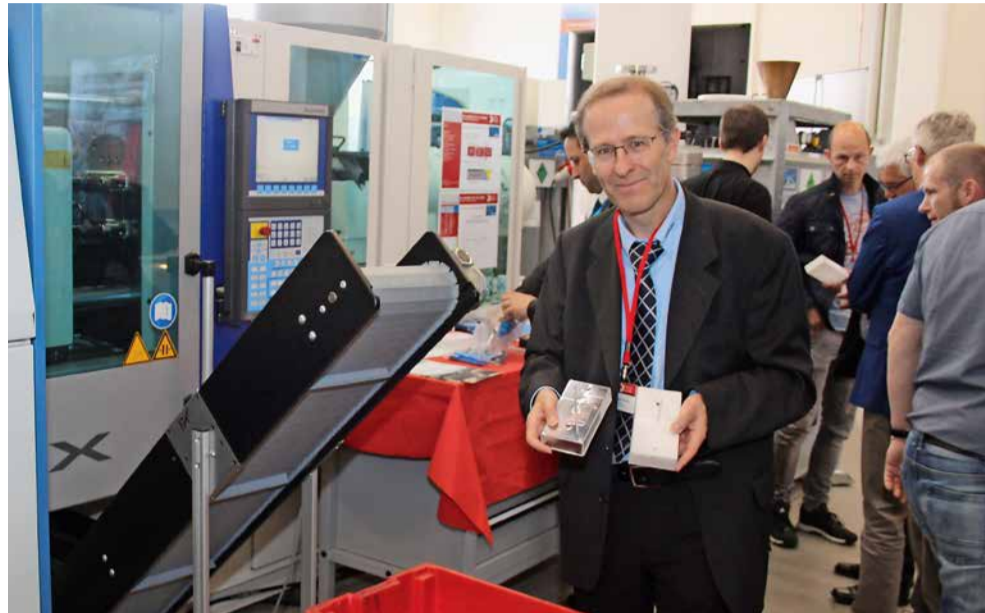
Neu vorgestelltes physikalisches Schäumverfahren bereits auf der Standardmaschine im Einsatz: Linde-Experte Andreas Praller mit Bauteilen kompakt (l.) und leichtgewichtig geschäumt (r.) im Technikum des Kunststoff-Instituts Lüdenscheid Foto: K-ZEITUNG
