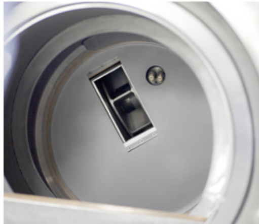
Stickstoff-Verdügungssystem in der Entgratungstrommel.
